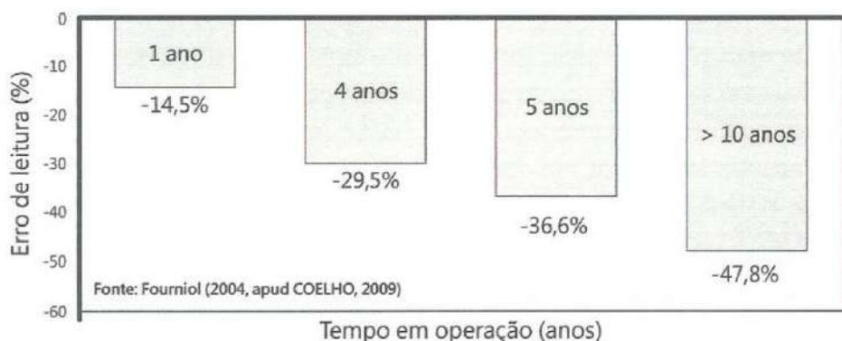
Figura 114 - Erros de medição de hidrômetros resultantes dos ensaios de hidrômetros domiciliares velocímetros em uma rede de distribuição de Maceió sem intermitência.
